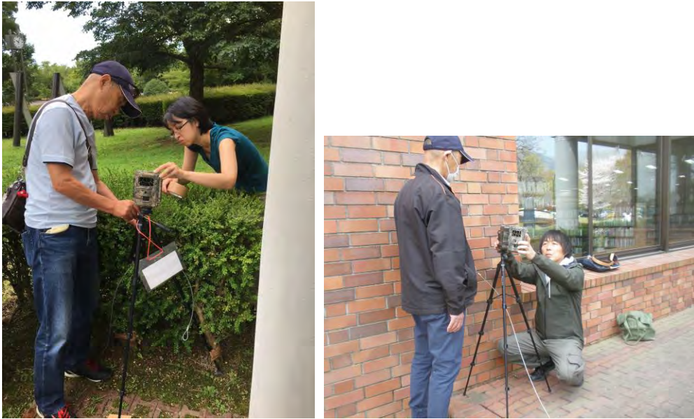
図7 センサーカメラ設置の様子。カメラは三脚に取り付けて地面から高さ約1mに固定した。カメラの向きは地面を撮影するように調整しており、シジュウカラのような小鳥にも反応する。
